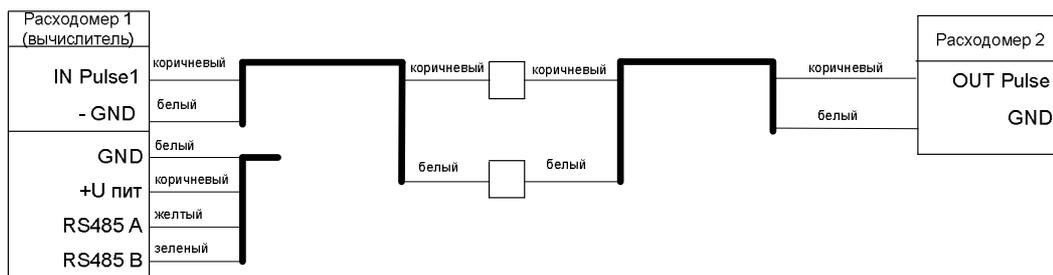
**СХЕМА ПОДКЛЮЧЕНИЯ ТЕПЛОСЧЕТЧИКА С ДВУМЯ РАСХОДОМЕРАМИ И ДАТЧИКАМИ ДАВЛЕНИЯ**
