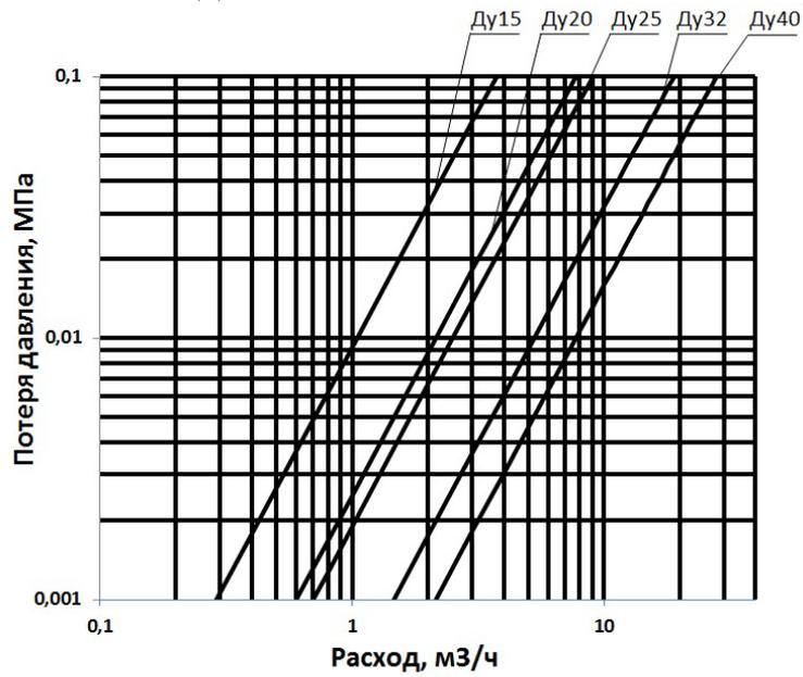
Для теплосчетчиков до 130 °С
